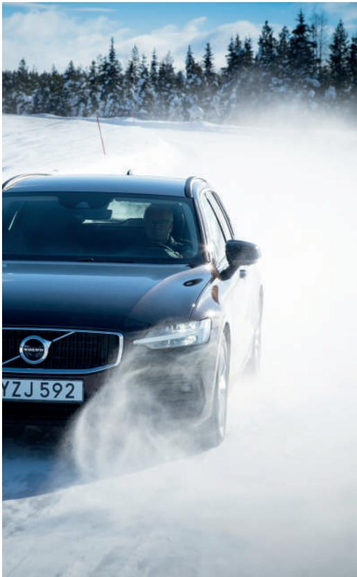
Vykonáva sa aj test ovládania vozidla, ktorý sa uskutočňuje na špeciálne upravenej trati na zamrznutom jazere. Počas tohto testu sa testuje niekoľko rôznych situácií ovládania vozidla – jazda v zákrutách, brzdenie a rýchle bočné manévre. Trať je úzka, približne kilometer dlhá a pozostáva z niekoľkých ostrých zákrut. Na všetkých skúšaných vozidlach sa pneumatiky mnohokrát menia, takže vodiči majú jasnú predstavu o rozdieloch medzi špeciálnymi vlastnosťami a charakteristikami každej pneumatiky.
