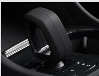
čalúnená hlavica radiacej páky, bez použitia kože
